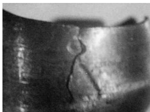
Фото 3. Трещина на корпусе гильзы от патрона к пистолету ТТ, отобразившаяся при стрельбе из самодельного огнестрельного оружия.
