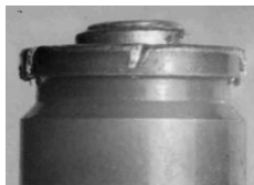
Фото 10. Гильза патрона 5,45×39 со смещенным (выдавленным) капсюлем, стрелянная из самодельного оружия
