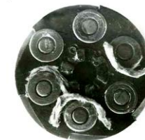
Фото 2. Барабан самодельного револьвера с патронами обернутыми бумагой для обеспечения плотного контакта с поверхностью камер барабана.
