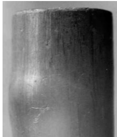
Фото 6. Гильза от патрона 9×18, стрелянная в самодельном огнестрельном оружии. На корпусе гильзы видны продольные следы-трассы, отобразившиеся от дефектов поверхности патронника и выступов-заусенцев на крае казенного среза ствола.
