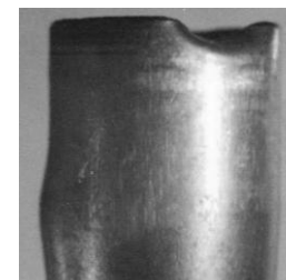
Фото 5. След-вмятина на дульце гильзы (патрон 9×18), отобразившийся при ее защемлении между патронным упором затвора и казенной частью ствола самодельного огнестрельного оружия.
