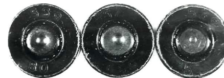
Фото 7. Следи от бойка ударника на капсюлях гильз 5.45×39, стреляных из самодельного оружия (на фото видны различия в расположении, форме и степени выраженности следов).
